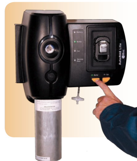
AutoRAE Lite Bump Test 및 교정 스테이션을 이용한 ToxiRAE 3 Bump Test
